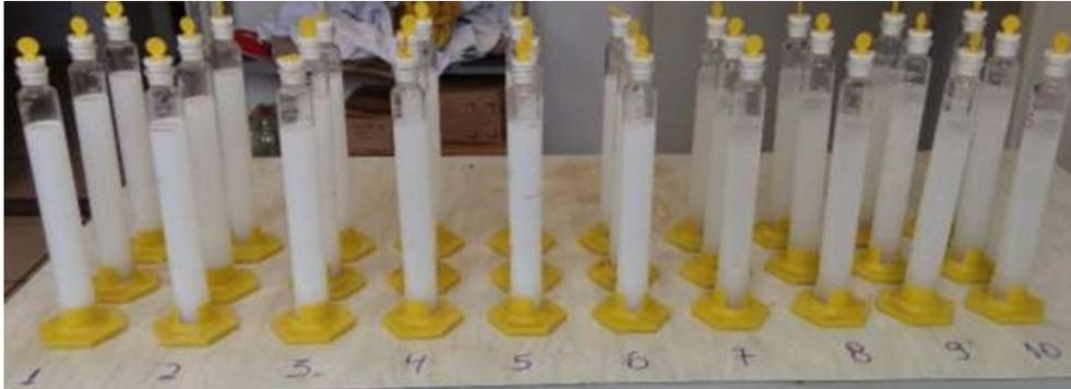
Figura 1. Disposição de provetas com calda fitossanitária para avaliações de estabilidade.
